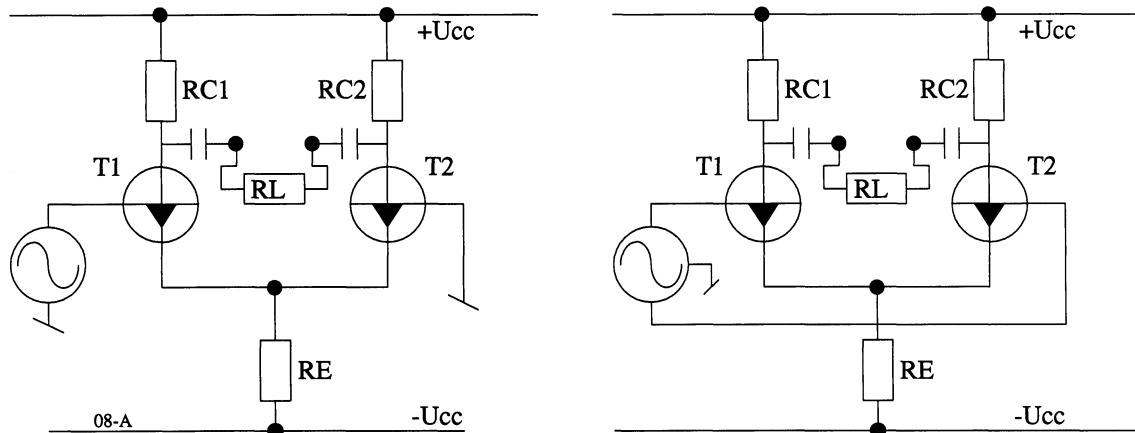
Differentialforstærkeren består af to transistorer, der er koblet sammen ved hjælp af en fælles emittermodstand.
