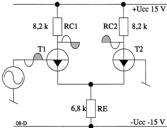
Når generatoren er tilsluttet som vist, er det et ubalanceret Different Mode signal, der tilføres indgangen.
