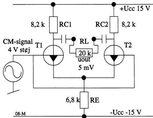
CMRR er et udtryk for forholdet mellem forstærkningen af et DM signal og et CM signal.
