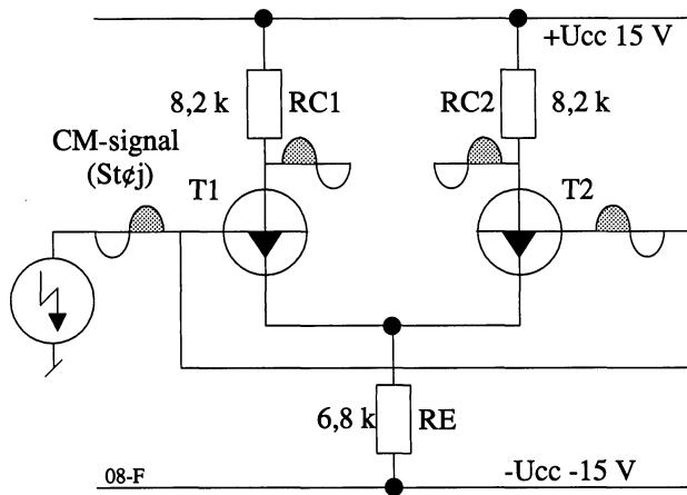
Hvis en differentialforstærker får tilført et DM signal, balanceret eller ubalanceret, er det et signal, vi ønsker at forstærke.
