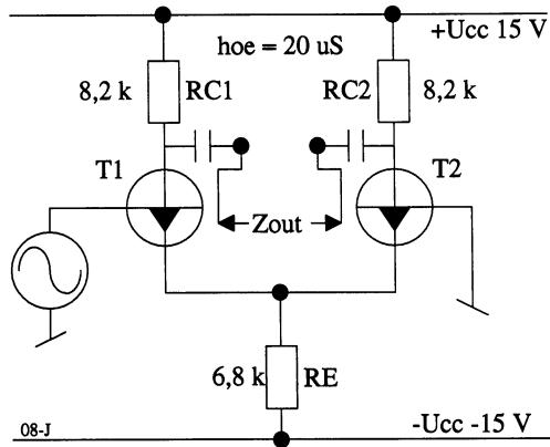
Udgangsimpedansen er bestemt af de 2 kollektormodstande og transistorernes udgangsimpedans.
