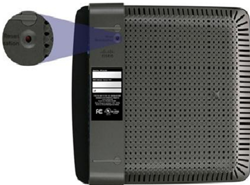
Figur Fejl! Ukendt argument for parameter. - Bunden af Cisco E3200 routeren med Reset funktionen
