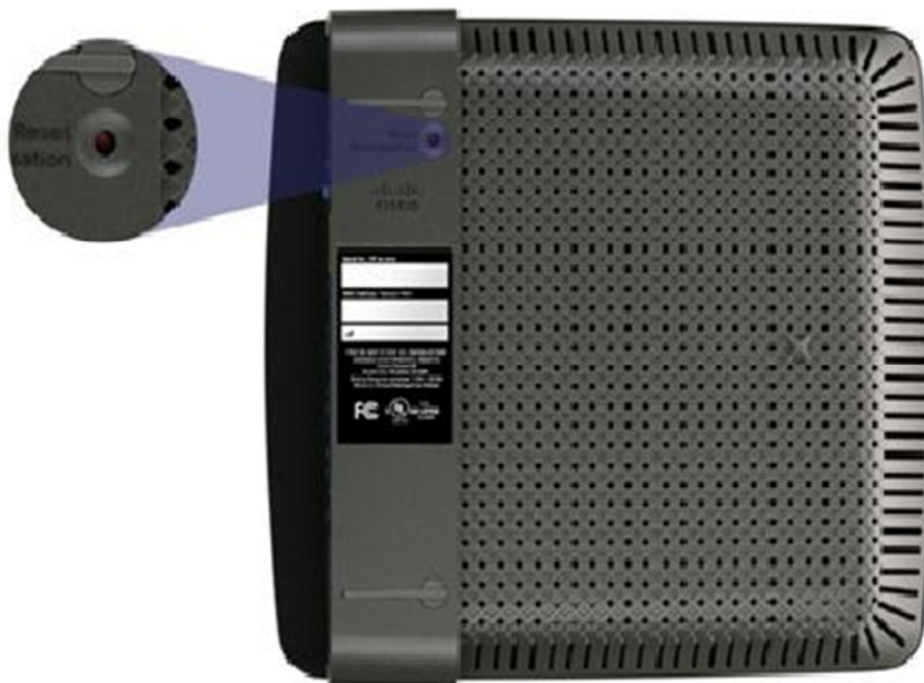
Figur 2 - Bunden af Cisco E3200 routeren med Reset funktionen
