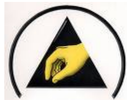
Indikerer - at enheden er special Designet - til at give ESD beskyttelse af bestykkede printkort og komponenter, som er ESD følsomme
